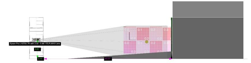
ELEVATION FOR EPSON PRO L1075U 7K -- FOCUSED ON SIDE WALL
